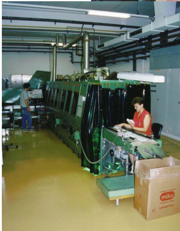
Mehrfarbiges bedrucken von Flaschen, Verschlüssen und technischen Teilen (Bild: 6 Farben UV-Siebdruckmaschine)
